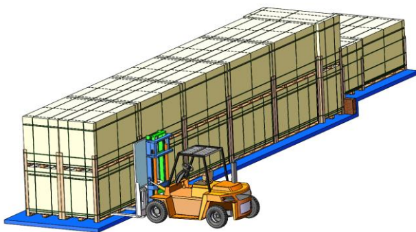
Scarico del pacchetto verticale sul lato corto e del pacchetto a forma di U con carrello elevatore
