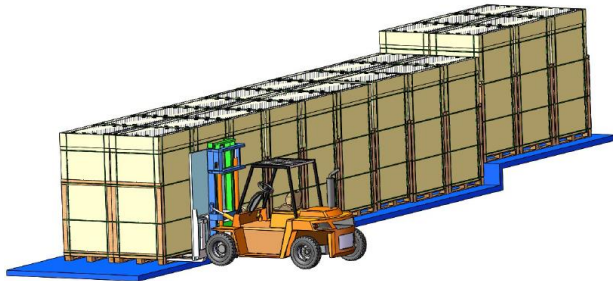
Scarico del pacchetto verticale sul lato lungo con carrello elevatore
