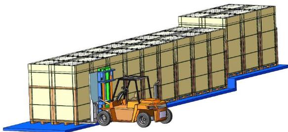
Scarico del pacchetto verticale sul lato lungo con carrello
